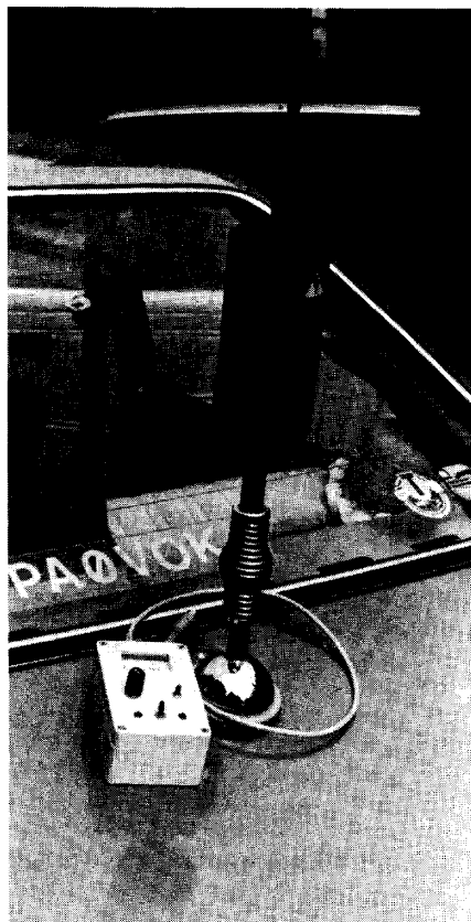
Foto 1. De antennevoet met spoel en bedieningskast.
